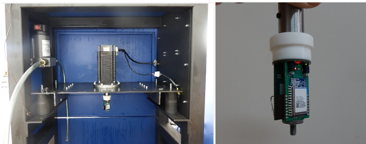
Rys. 1. Zdjęcie wahadłowego układu pomiarowego oraz widok elektrometru wirującego z zasilaniem bateryjnym i bezprzewodową transmisją danych pomiarowych.
